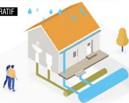
La mise en séparatif consiste à installer un réseau pour les eaux usées et un autre pour les eaux pluviales.
