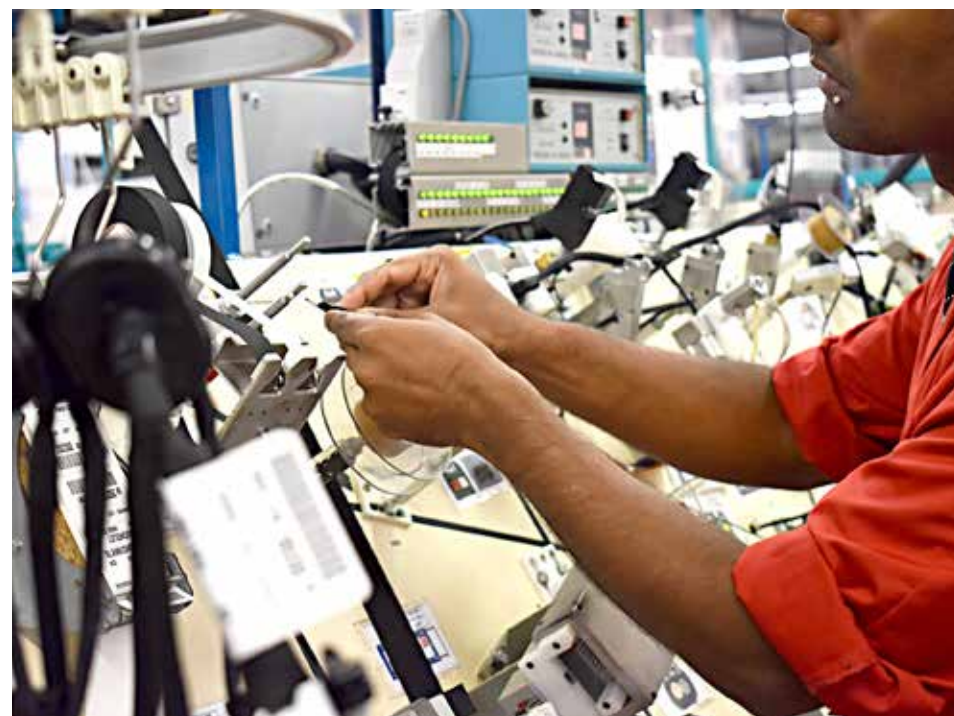
Le câblage électrique représente la majeure partie de l'activité de l'Amipi. La fabrication est décomposée en plusieurs étapes, afin que chaque salarié puisse trouver sa place, en fonction de ses capacités, et monter en compétences.
