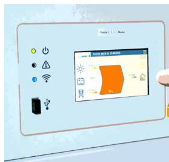
L'énergie solaire passe par un onduleur qui transforme le courant continu en courant alternatif.
