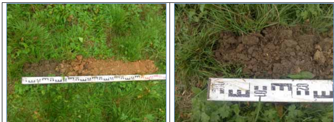
Sondage n°73 : Présence de traits rédoxiques entre 15 et 25 cm de profondeur, intensité augmentant avec la profondeur jusqu'à 1.20 m. Traces réductiques à partir d'1.0 m. (sol de type V b).
