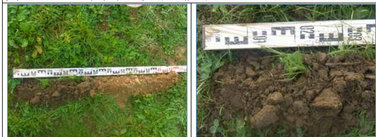
Sondage n°62 : Présence de traits rédoxiques entre 15 et 25 cm de profondeur, intensité augmentant avec la profondeur jusqu'à 1.20 m. Présence de quelques pieds de joncs. (sol de type V b).
