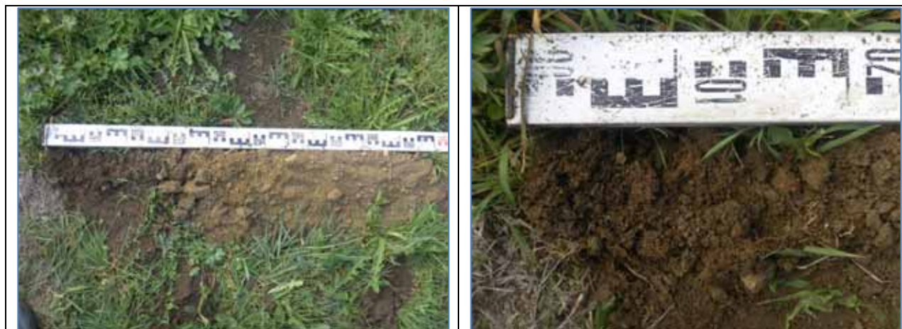
Sondage n°24 : Présence de traits rédoxiques entre 15 et 25 cm de profondeur, intensité augmentant avec la profondeur jusqu'à 1.20 m (sol de type V b).
