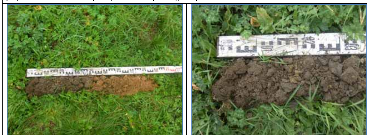
Sondage n°105 : Présence de traits rédoxiques entre 15 et 25 cm de profondeur, intensité augmentant avec la profondeur jusqu'à 1.20 m. (sol de type V b).
