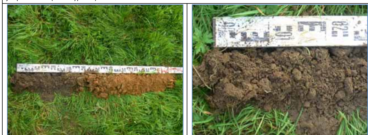
Sondage n°133 : Présence de traits rédoxiques entre 15 et 25 cm de profondeur, intensité augmentant avec la profondeur jusqu'à 1.20 m. (sol de type V b).
