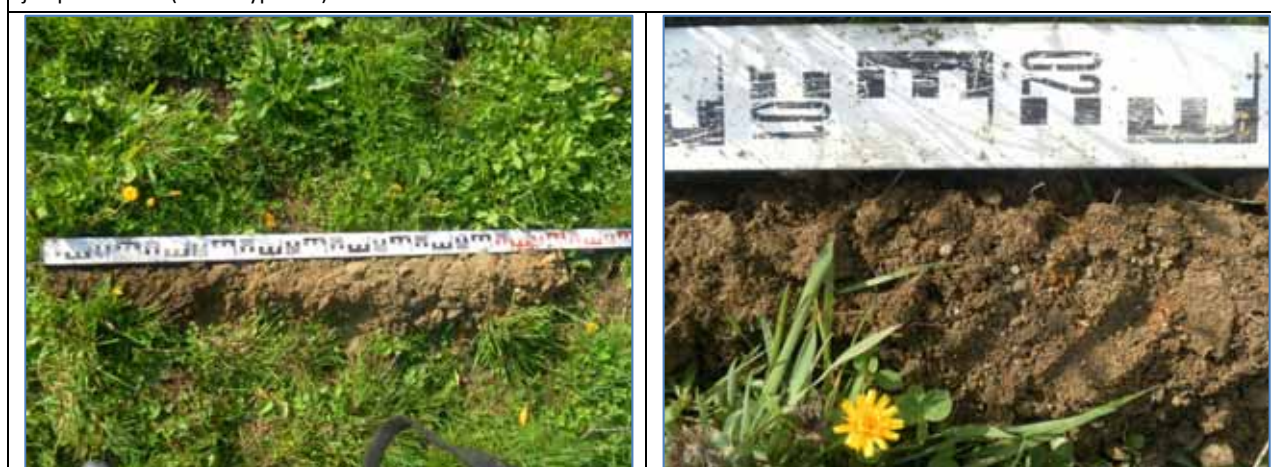
Sondage n°27 : Présence de traits rédoxiques entre 15 et 25 cm de profondeur, intensité augmentant avec la profondeur jusqu'à 1.20 m. Présence de quelques pieds de joncs. (sol de type V b).
