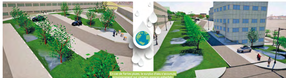
En cas de fortes pluies, le surplus d'eau s'accumule provisoirement sur certains espaces enherbés. Cet excès d'eau est progressivement absorbé par le sol.
